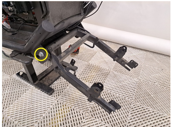
Irrota takahaarukan kiinnityspultti ja vastamutteri. (kiintoavain 14 mm ja 17 mm).
