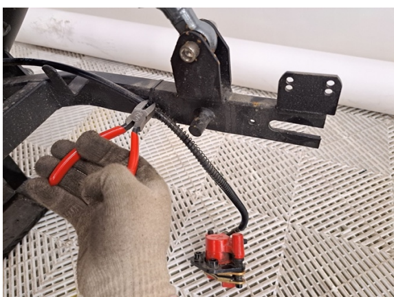
Leikkaa takajarruletkua kiinni pitävät nippusiteet. (sivuleikkuri).
