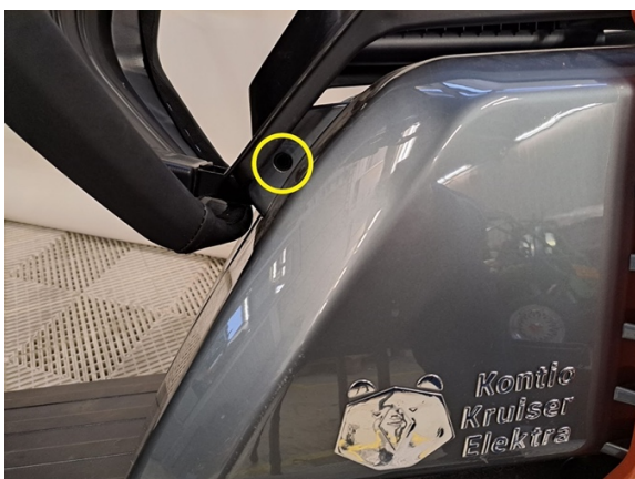
Irrota vasenta kylkipaneelia kiinni pitävä kiinnitysrivi. (ristipäämeisseli ph2).
